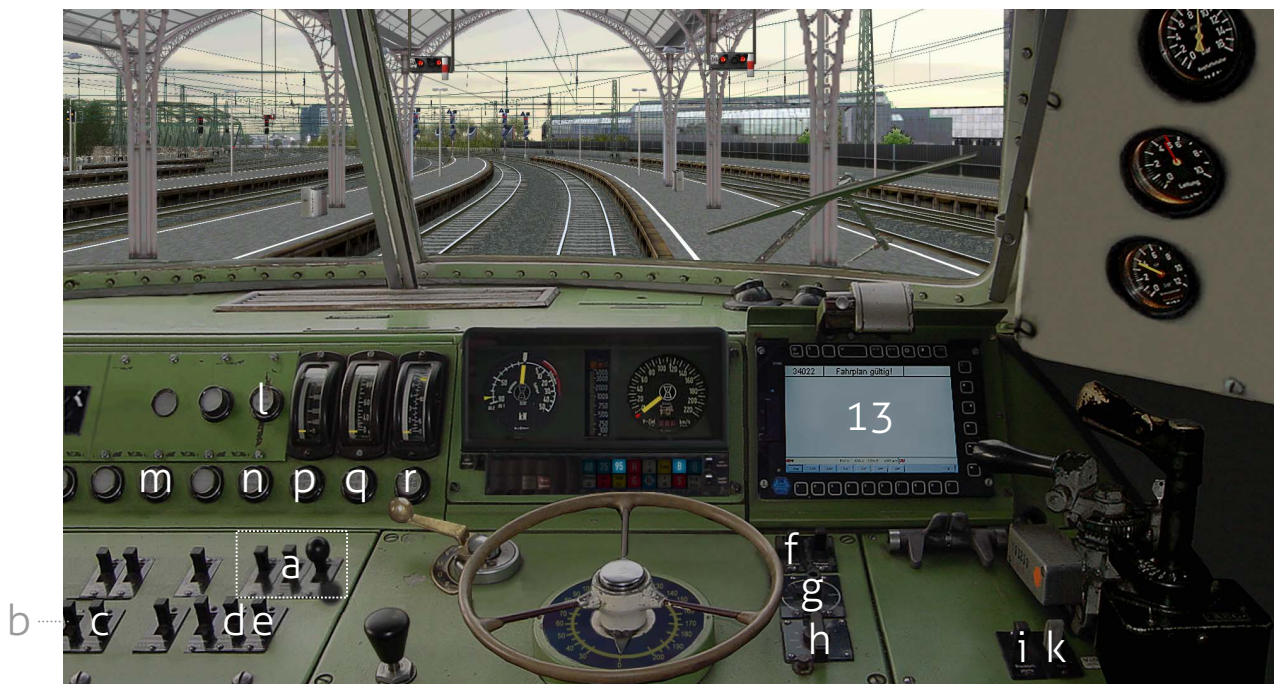
Knapp 30 Jahre später sind verliebene Maschinen der Baureihe 103 vor allem vor Sonderzügen im Einsatz. Das nachgerüstete EbuLa-Display erhöht den Komfort für den Lokführer deutlich.
