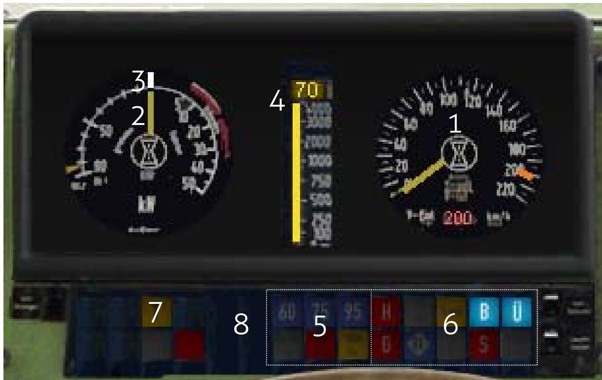
Die Modulare Führerraumanzeige in der Simulation im LRB-Betrieb
